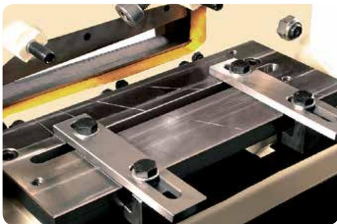
Sistema antitorsión para corte de llantas sin deformación
