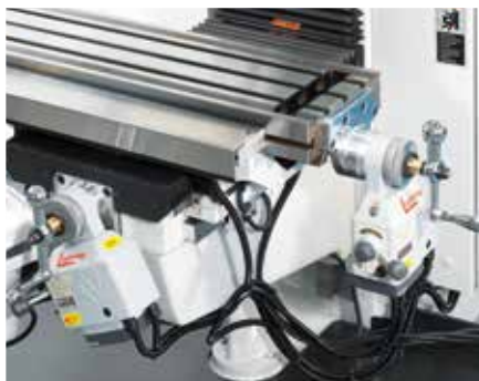
Caja electrónica de avances para los ejes X e Y Electronic power feed for X and Y axes Elektronischer Vorschubkasten für die X- und Y-Achsen Boîte électronique d'avances pour les axes X et Y
