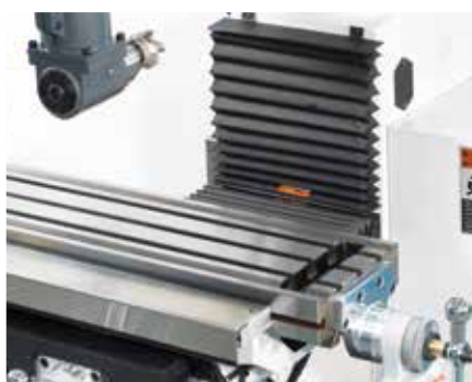
Fuelle protector de virutas Protection by means of bellow Späneschutz durch Faltenbalg Protection au moyen de soufflets
