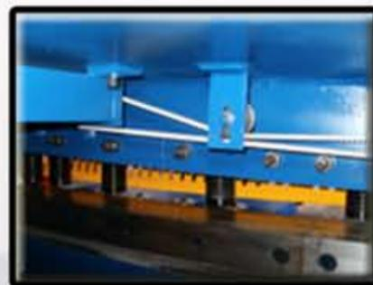
Las correas dentadas de goma, carentes de mantenimiento, junto con el husillo de bolas y los patines guía hacen el desplazamiento del tope rápido y silencioso incluso en el momento de máximo esfuerzo cuando la barra del tope se levanta en la parte trasera para permitir cortar chapas más largas de la medida máxima del visualizador.
