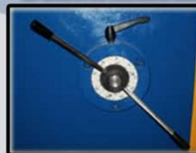
El separador de cuchillas manual está instalado en un lado de la máquina, esto reduce posibles olvidos del operario en el momento de separar.
