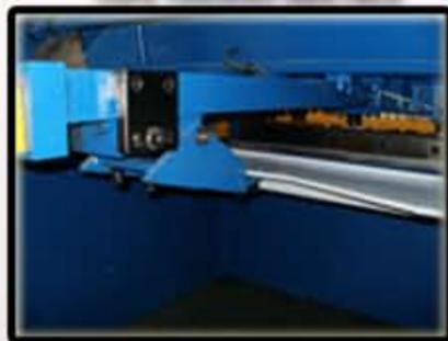
La barra del tope se abate cuando llega al límite trasero de su carrera, con ello permite cortar una chapa más larga de la medida máxima del tope (700mm). El procedimiento es automático, reversible y no necesita ningún ajuste ni manipulación mecánica.
