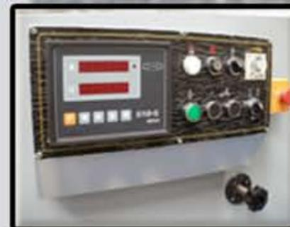
El visualizador digital de cotas se ha convertido en una herramienta indispensable para poder cortar rápida, precisa y eficazmente.
