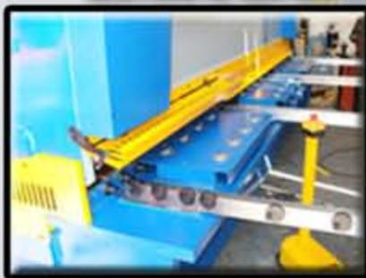
La reja frontal abatible permite acceder y tener visibilidad de la zona de corte de una forma rápida y segura.
